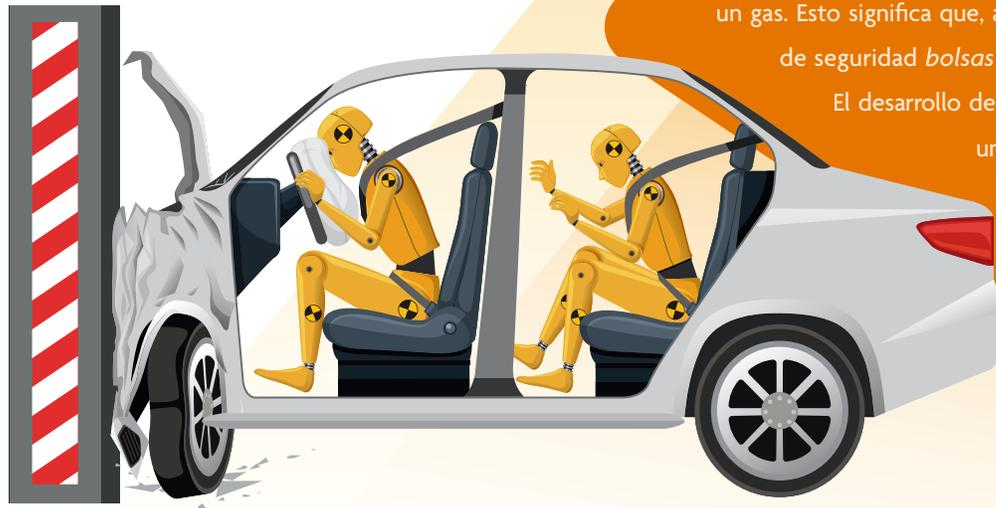
Al interior de un sistema de bolsas de seguridad ocurren varias reacciones químicas, ¡sí, léste bien! El gas que infla estas bolsas no proviene de un tanque presente en el automóvil, ni recoge aire del ambiente y lo arroja a presión al momento de una colisión, se produce por una reacción química en la que se forma un gas. Esto significa que, aunque comúnmente llamamos a este sistema de seguridad *bolsas de aire*, el gas que infla las bolsas no es aire.
