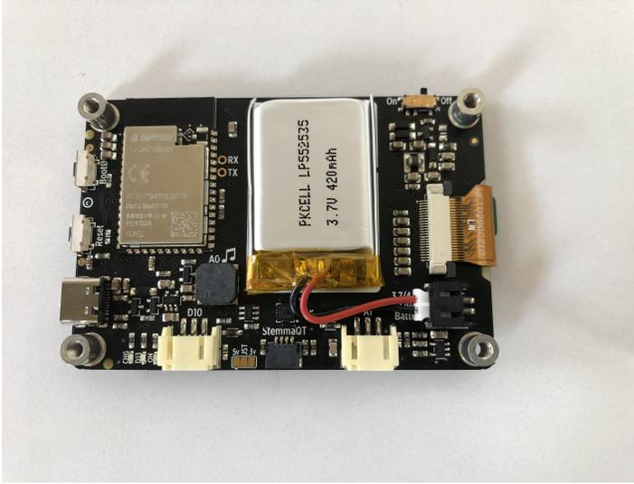
Figura 3.1: Paso 1: *unión de pila a MagTag*
