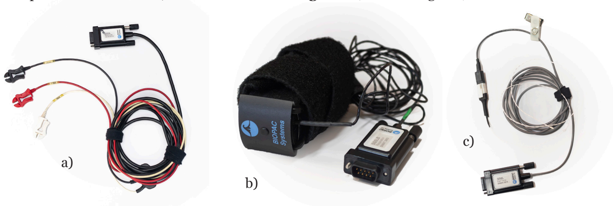
Figura 1. a) Transductor de registro para neumografía (MP35), b) Transductor respiratorio y c) Transductor con termisor nasal.
