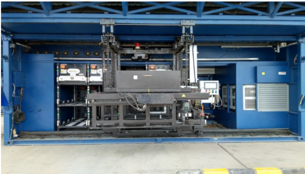
Figura 6.9: Brazo mecánico que intercambia la batería debajo del chasis del autobús.
