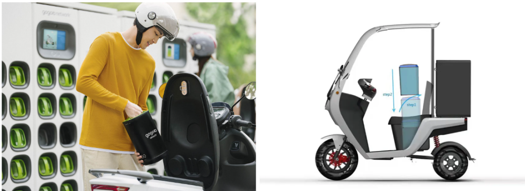
Figura 6.1: Fotografías del intercambio y posición de las baterías en vehículos de dos ruedas. A la izquierda se observa la marca Gogoro 19 , a la derecha Tycorun 20 .
