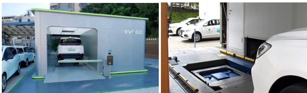
Figura 6.3: Estación de intercambio de EVOGO 28 a la izquierda y a la derecha se observa la posición del paquete de baterías para intercambiar en una estación de INFRAmobility-Dianba ubicada en Berlín, Alemania 29 .
