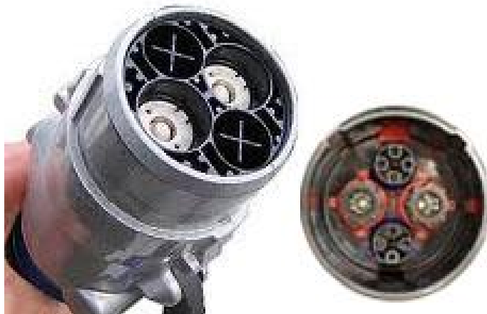
Figura 2.5: Conector para vehículo eléctrico tipo CHAdeMO.
