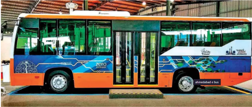
Figura 6.8: Autobús eléctrico de baterías intercambiables en Ahmedabad 48 .
