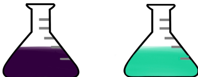
Figura 8.1. Coloraciones que adquiere la muestra problema durante la titulación para determinar la concentración de carbono orgánico del suelo por el método de Walkley y Black. Izquierda, color púrpura de la muestra durante de la titulación. Derecha, color verde esmeralda que toma la muestra al término de la titulación.
