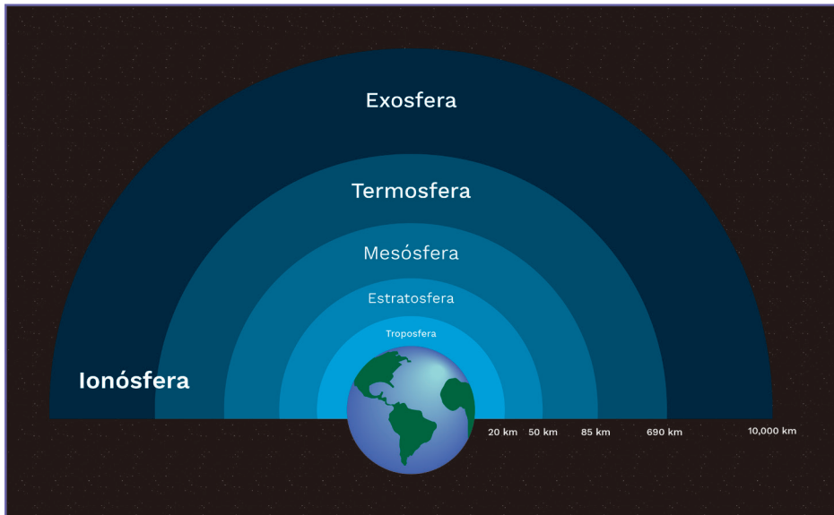
Figura 17. Representación de la ionósfera y su relación con las cinco capas de la atmósfera terrestre. La ionósfera tiene propiedades físicas muy importantes: nos protege de la radiación más energética del Sol y refleja las ondas de radio. Debido a que las señales de las telecomunicaciones (antena-satélite) tienen que atravesar esta capa, si se presentan perturbaciones ionosféricas se producen pérdidas de información. Ilustración de Axel García Pineda.
