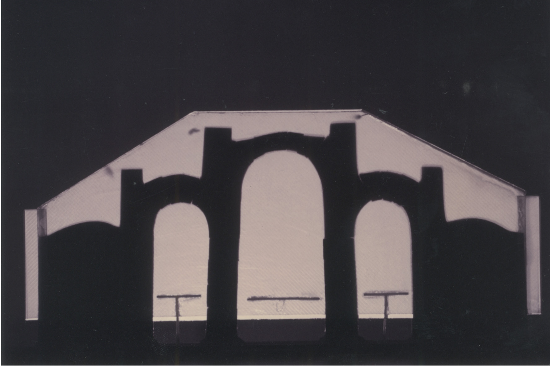
▲ Imagen del modelo sin solicitaciones por hundimiento del suelo: geometría ideal.
